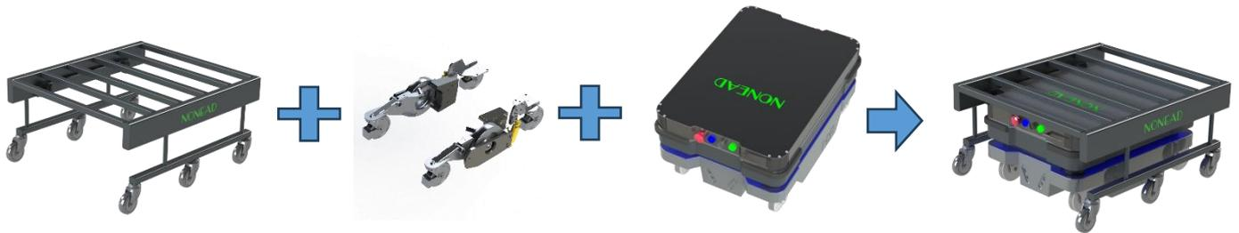
MiR250 + NH0211\_nMiRBTS + NH0260\_增载机构套装 + NH0293\_大负载基准料车 最大负载 500KG
