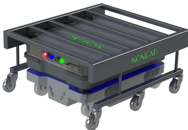
MiR250+nMiRBTS\_CB5 底部牵引大负载基准料车
